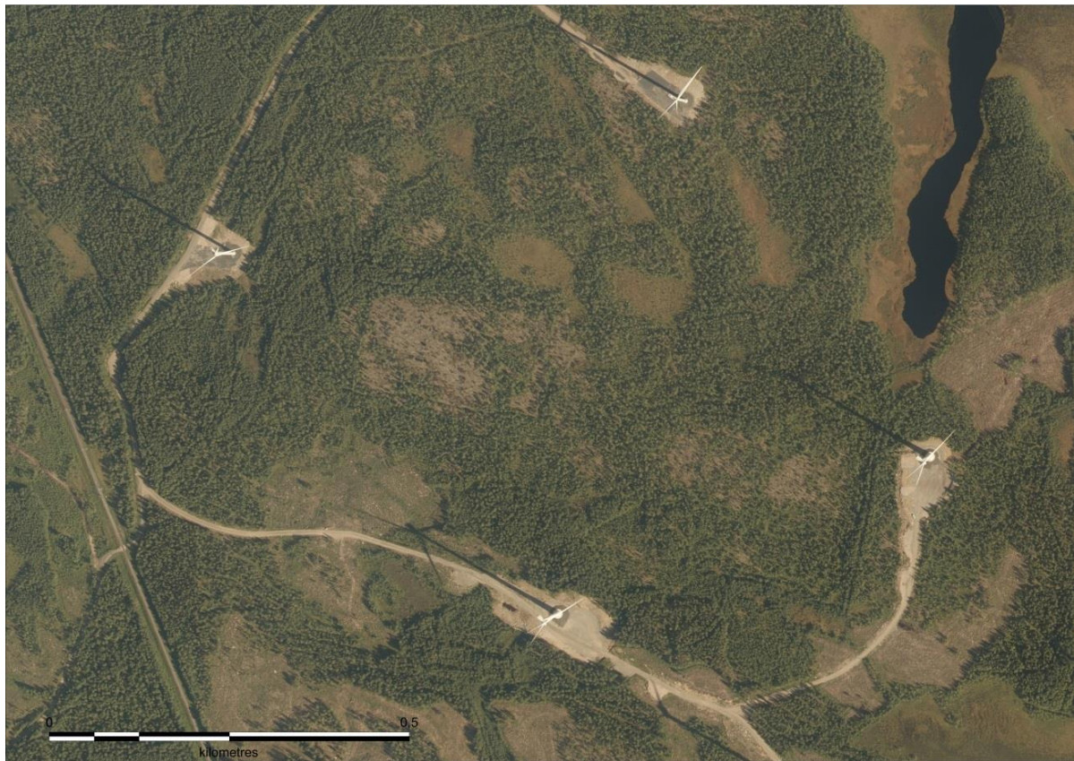
Kuva 73. Ilmakuvassa näkyy toiminnassa olevia tuulivoimaloita. Tuulivoimaloita varten on rakennettu huoltotiet ja nostokentät. Tuulivoimaloiden ympäristössä ja välialueilla aikaisempi maankäyttö on säilynyt ennallaan.
