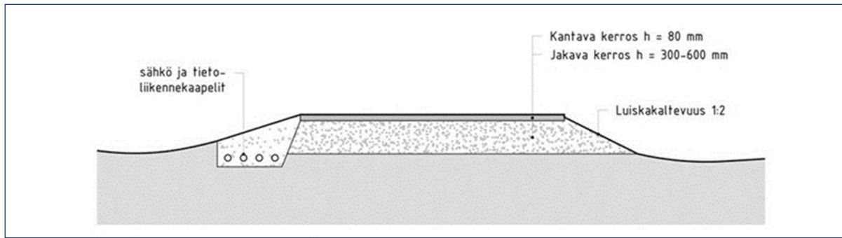
Kuva 9-27. Periaatekuva uuden ja parannettavan tien rakenteesta (Sitowise 2023).
