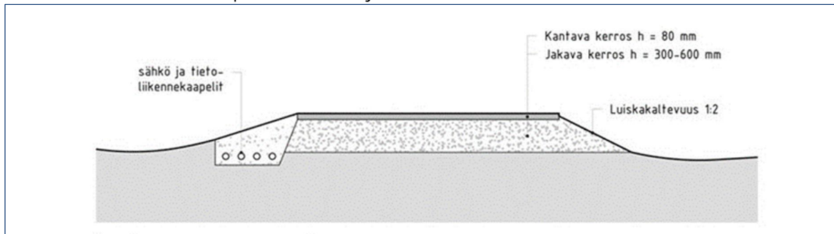
Kuva 9-32. Periaatekuva uuden ja parannettavan tien rakenteesta (Sitowise 2023).
