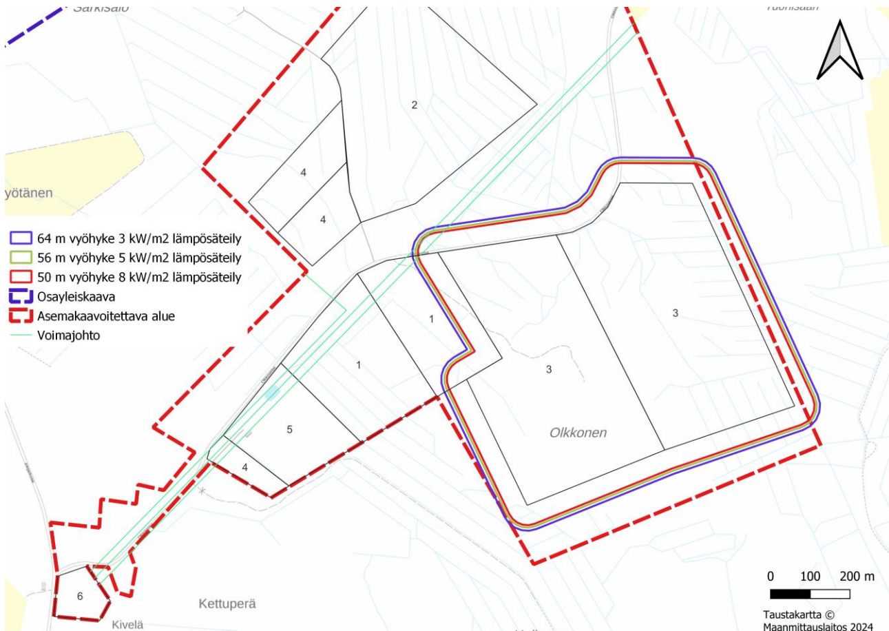
Kuva 11. Vetyputken vuodon suihkupalon lämpösäteilyn vaikutusalueet, kun vuotokohta sijaitsee jossakin kohtaa tontin reunaa
